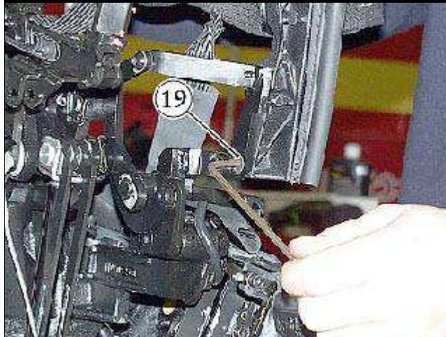
● 松开将后拱末端紧固到内侧以支撑运动机构臂的螺钉**(19)**。
