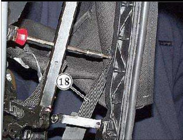
● 分离带 (18) 及其护罩, 拧下将其紧固至后拱内侧的螺钉及垫圈。
