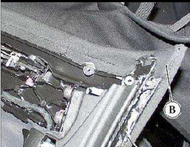
● 从之前粘接到车顶前框架横梁的双面胶带上去除保护纸。
